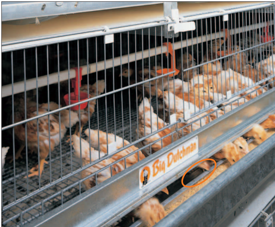
Kükenetage mit durchgängigem Freßschlitz und Troginnenkrempe gegen Futterverluste
