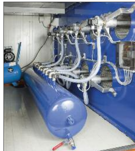
Automatische Druckluftreinigung der Filtereinheit
