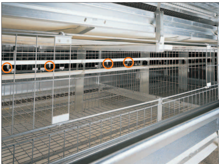
Piętro dla starszych kurek w baterii UV-S 630 – cztery smoczki ze stali nierdzewnej dostarczają ptakom świeżej wody
