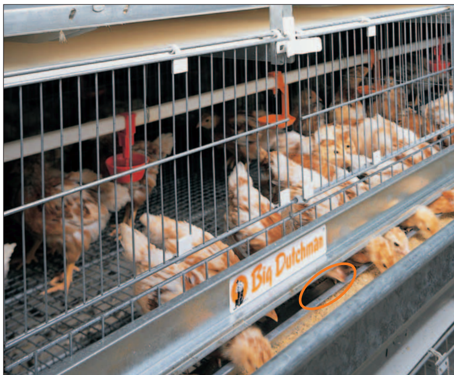
Piętro dla piskląt z ciągłą kontrolą pobierania paszy i wewnętrznym kołnierzem korytka, zapobiegającym stratom paszy
