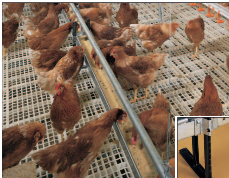
Kury mogą pobierać paszę z obu stron korytka, a cały paszociąg może być podciągany do sufitu w celu ułatwienia sprzątania kurnika
