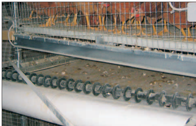
Taśma do usuwania pomiotu pod strefą pojenia i zadawania paszy w instalacji NATURA-Floor
