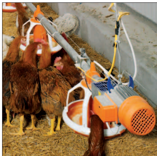
Paszociąg AUGERMATIC z karmidłem MALE PAN i napędem Rapid Rooster dla osobnego żywienia kogutów
