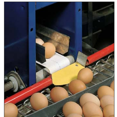
Przekazywanie jaj z przenośnika wzdłużnego na poprzeczny
