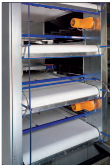
Urządzenie końcowe usuwania pomiotu oraz kanał poprzeczny
