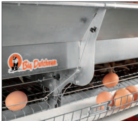
EggSaver w pozycji opuszczonej => staczanie się jaj jest znacznie spowolnione
