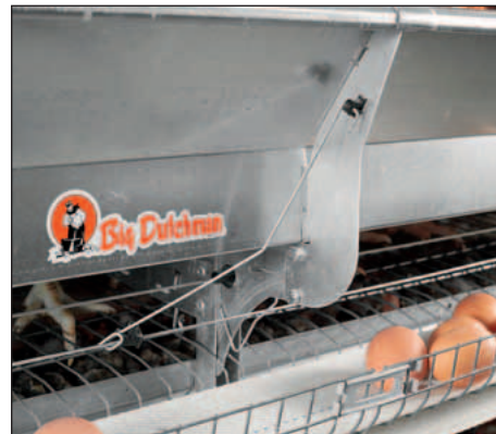
EggSaver w pozycji podniesionej => jajo stacza się swobodnie na taśmę
