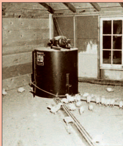
Первая система цепной кормораздачи США, 1938 г.
