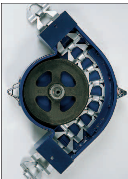
Угол 90° с кормовой цепью ЧЕМПИОН
