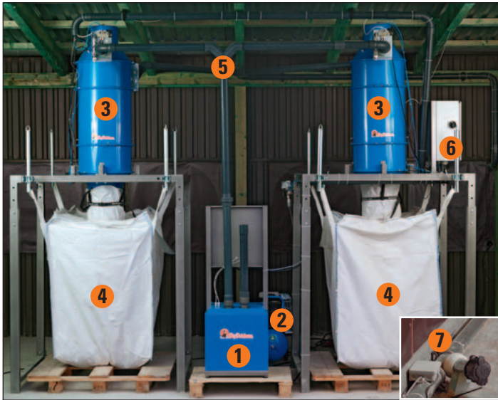
Установка по удалению пыли для полуавтоматической чистки фильтра StuffNix
