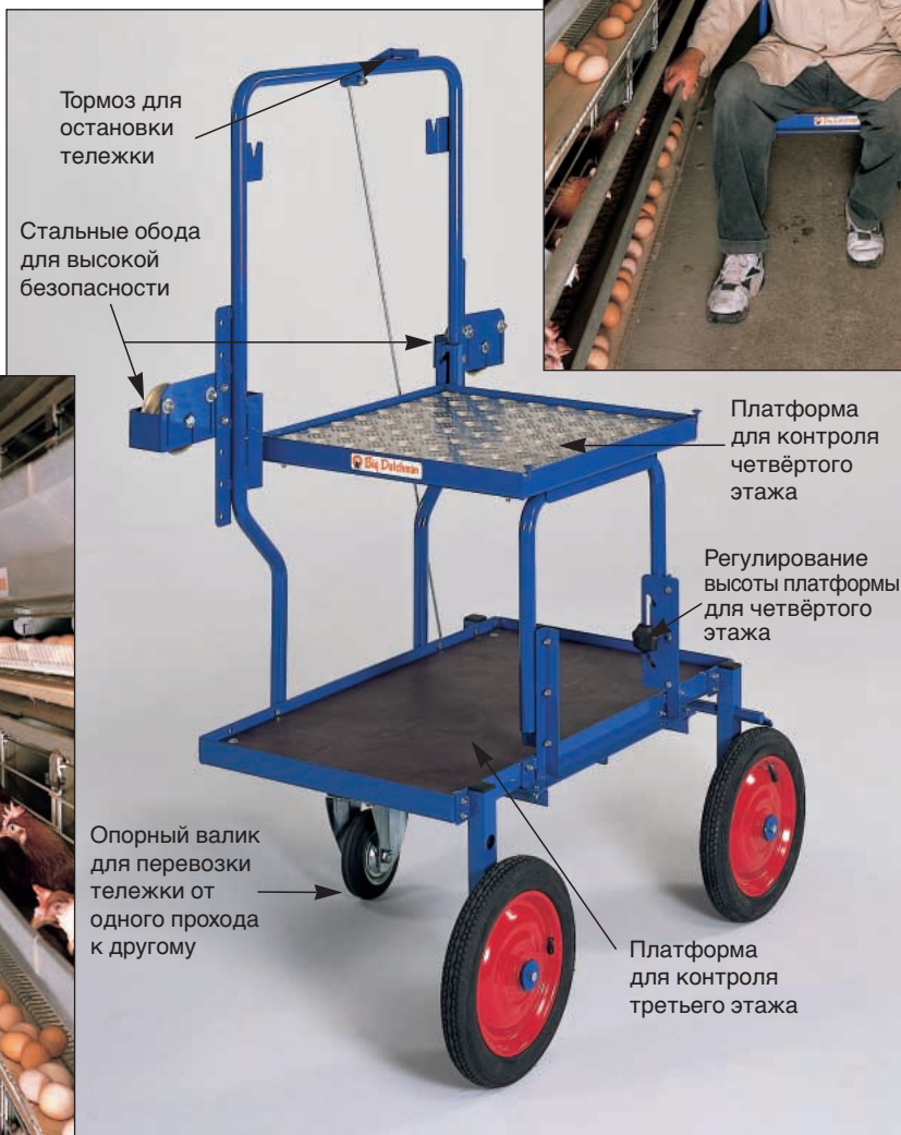
Контрольная тележка для клеточной батареи до четырёх этажей
