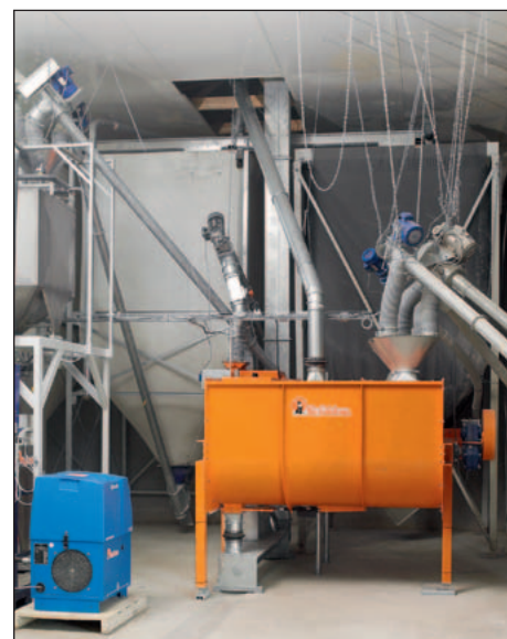
Horizontalmischer fördert die fertige Futtermischung in eine HydroAir-Flüssigfütterung
